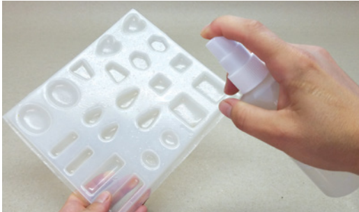
Separáčn í sprej usnadn í vyjmut í výrobku z formy.
