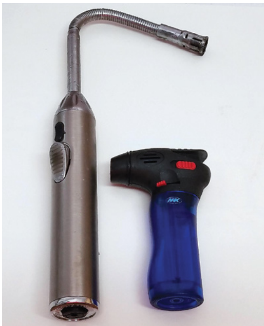
Bublinek se nejlépe zbavíte pomocí ručního plynového hořáku.
