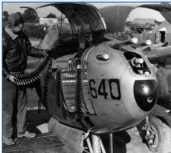
P-38 Lightning nesl v přídí kanon ráže 20 mm a čtyři velkorážní kulomety.
