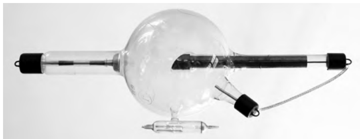
Obr. 1: Crookesova trubice z muzea Wilhelma Conrada Röntgena ve Würzburgu, s níž bylo objeveno rentgenové záření. © Aida/Wikimedia
