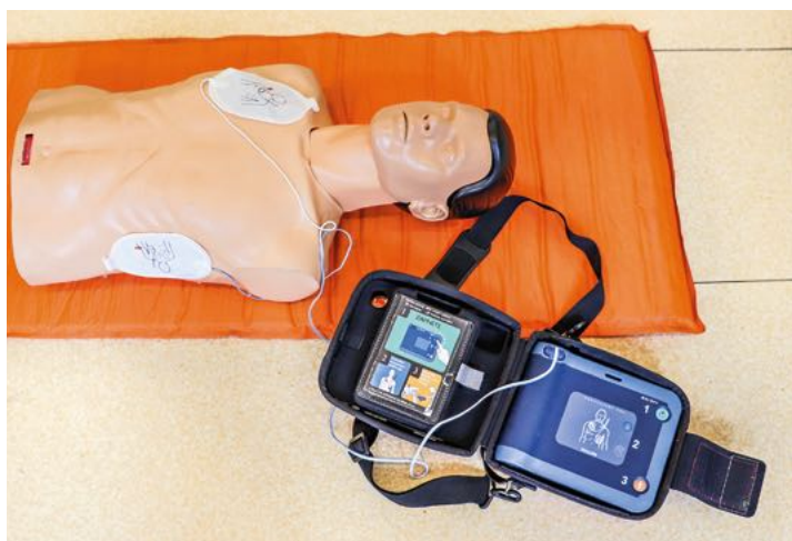
Obr. 1.13 Automatizovaný externí defibrilátor
