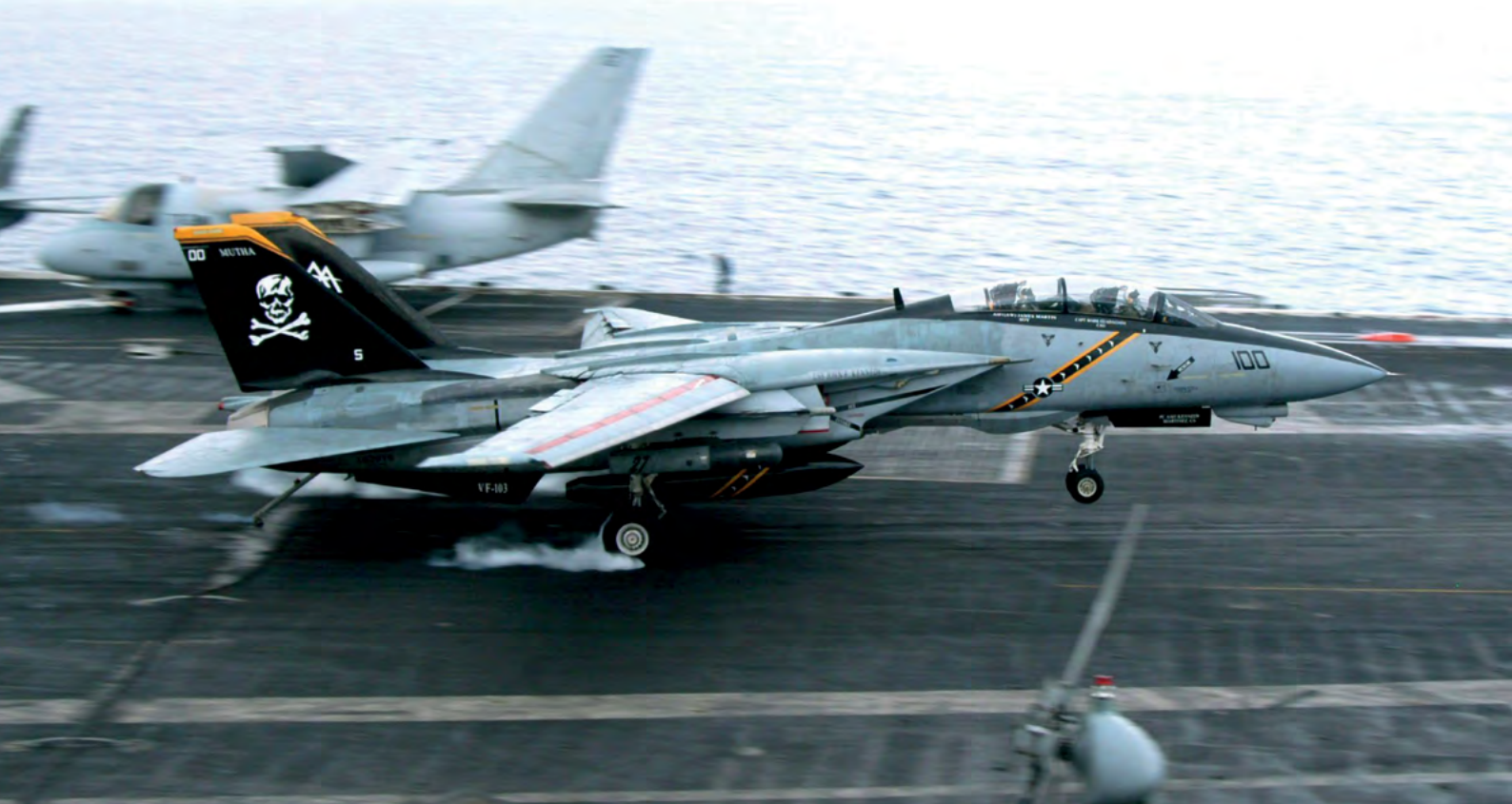
Sériový letoun F-14A Tomcat během záhytu přistávacího lana po dosednutí na palubu lodi USS John F. Kennedy, stroj se vrací z cvičného letu a nese výzbroj.
