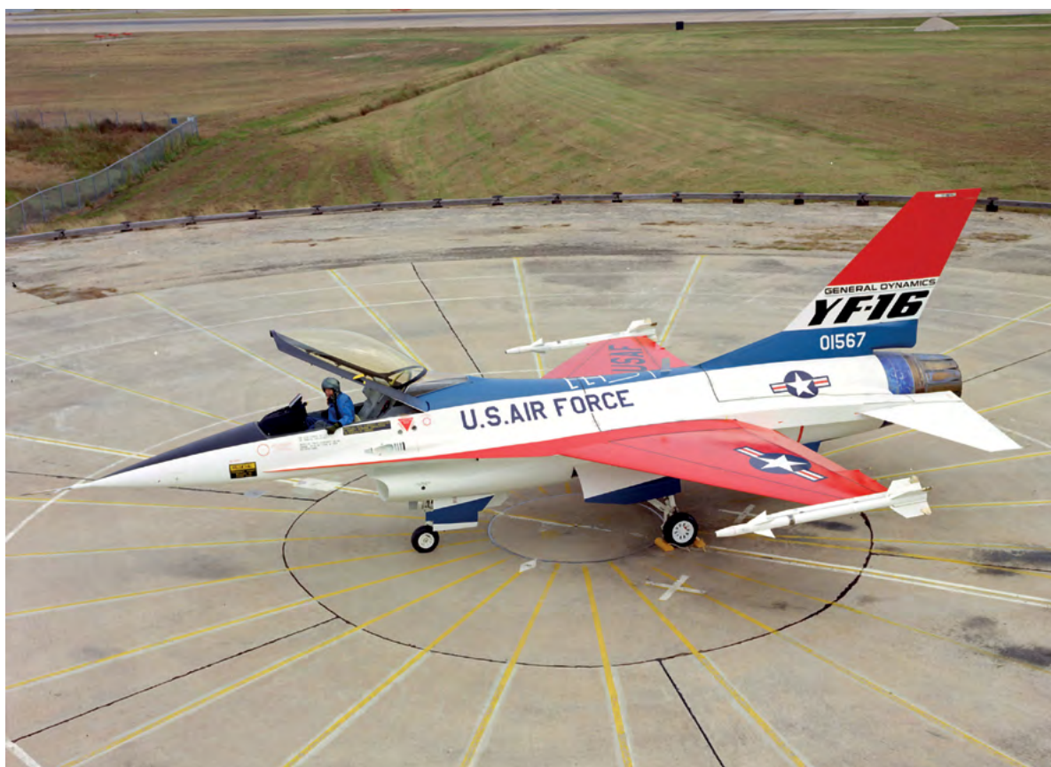
První prototyp YF-16 v testovacím zbarvení na kompenzačním kruhu, na němž se ustavují navigační systémy letounu.
