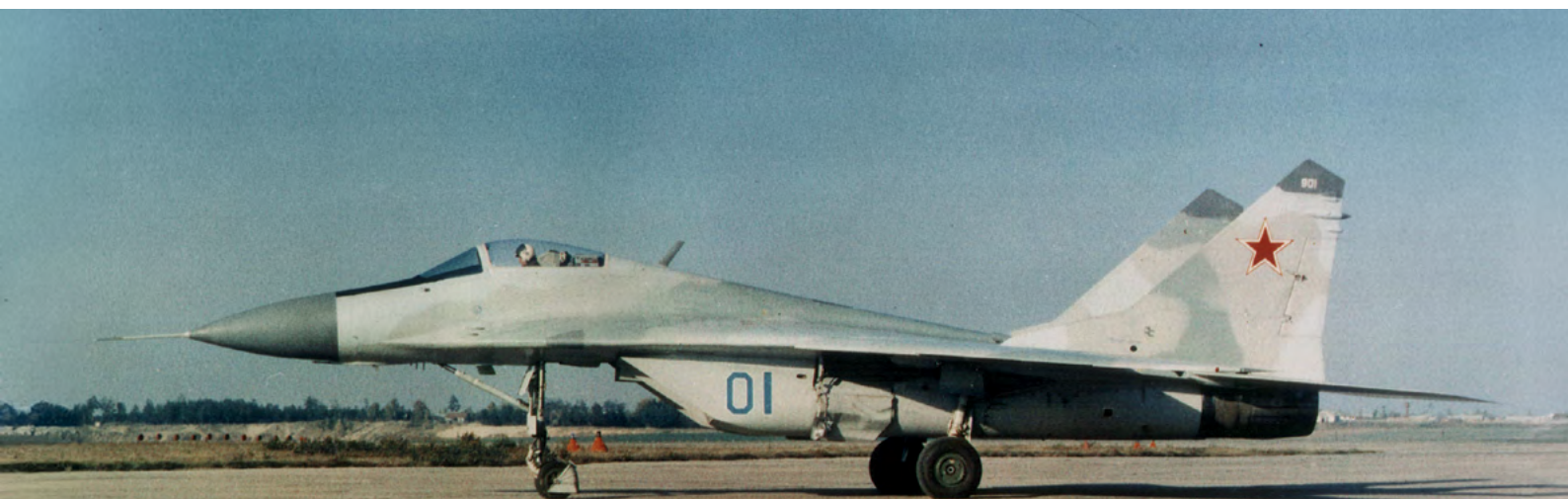
První letový prototyp letounu MiG-29. Stroj nese speciální kamufláž navrženou sovětským výzkumným ústavem letectva pro snížení optické zachytitelnosti.
